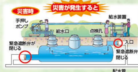
▲非常用貯水槽
