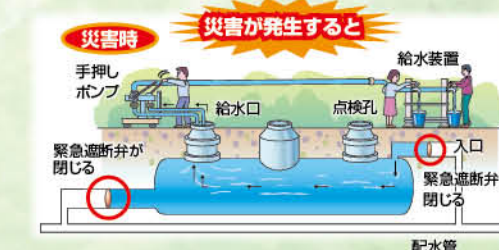
▲非常用貯水槽
